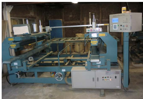
～裁断機～ 長い方の寸法を規格に合わせるため、 畳床を必要な長さにカットする
